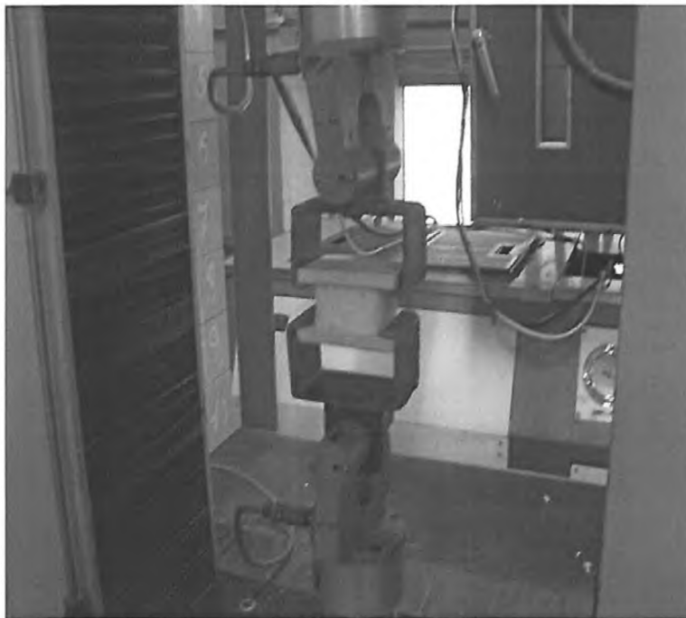
Рисунок 6 — Пример крепления образца в разрывную машину при определении прочности на растяжение пенного уплотнителя
